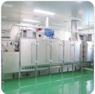
State-of-the-art tunnel roaster (high temperature> low temperature> cooling) 최신 터널식 로스터 (고온> 저온> 냉각)
